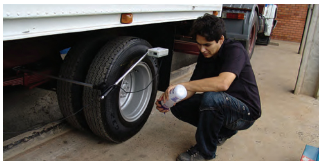
Fiscal faz verificação em cronotacógrafo: medição confiável
